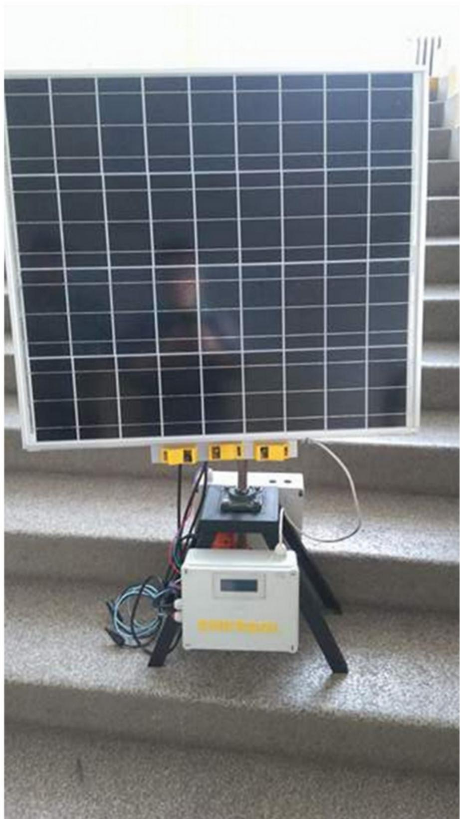
Celý systém je napájen dvojicí gelových akumulátorů, 12V akumulátory jsou spojeny do série a tím vznikne napětí 24V potřebných pro napájení motorů a čidel. Samotné arduino je napájeno 7 V, které se za pomocí měniče napětí získá z 24 V dodávaných akumulátorů.
